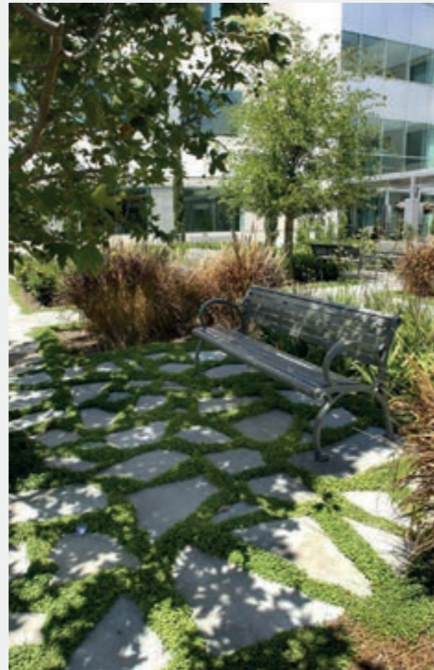
Opus incertum en pierre naturelle (gneiss/granit) et joints enherbés
